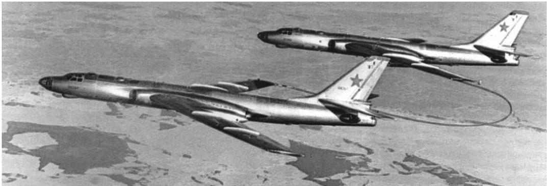
Рисунок 1 – Самолеты Ту-16 в строю крыльевой заправки
