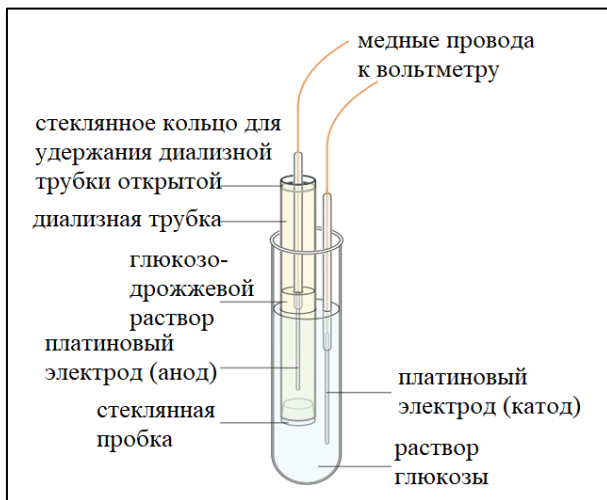
Рисунок 1 – Схема строения гальванического элемента, созданного Поттером
